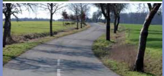
Auch einstreifige Verbindungswege können Fahrbahnbreiten von bis 4,50 m, befahrbare Seitenstreifen von zusammen 2,00 m und Kronenbreiten von 6,50 erhalten. Dabei können die befahrbaren Seitenstreifen unterschiedlich breit sein, so dass im Begegnungsfall ein Fahrzeug auf der Fahrbahn verbleiben kann.
